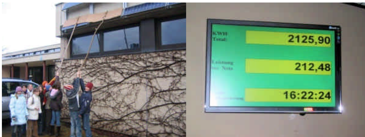
Abbildung 46 und 47: Klasse 8c bei der Teilbeschattung der PV-Anlage und Datenanzeige mit 22“-Flachbildschirm.
