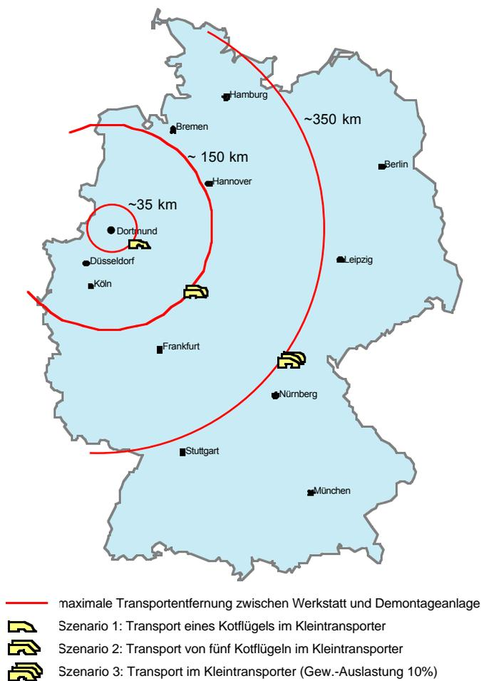
Abb. 11: Transportszenarien für den Aufbau von Altteilenetzwerken unter energetischen Gesichtspunkten
